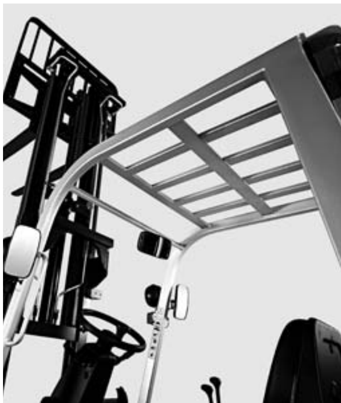
Окна в крыше кабины водителя для хорошего обзора вверх
